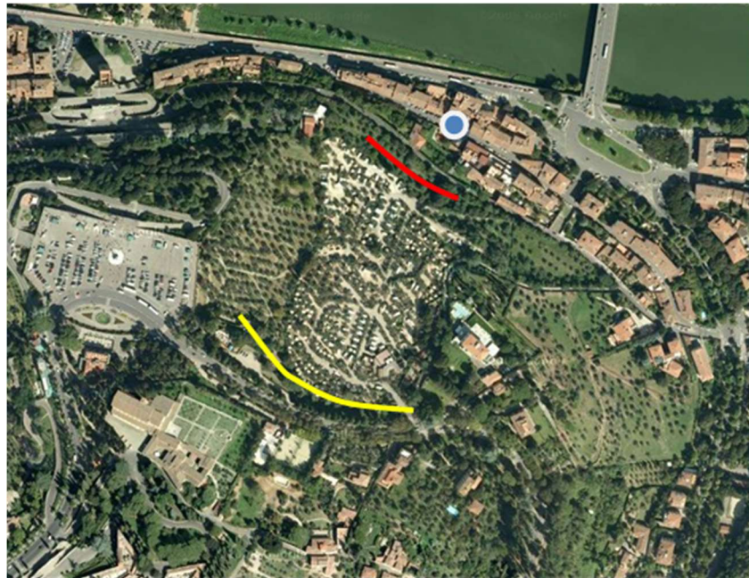
Figura 2 – Possibili ubicazioni della cava di argilla in epoca rinascimentale: linea rossa: rottura di pendio a quota 60 m ca.; linea gialla: rottura di pendio a quota 100 m ca.; disco bianco/azzurro: Via della Fornace (Immagine: Google Maps ©)
