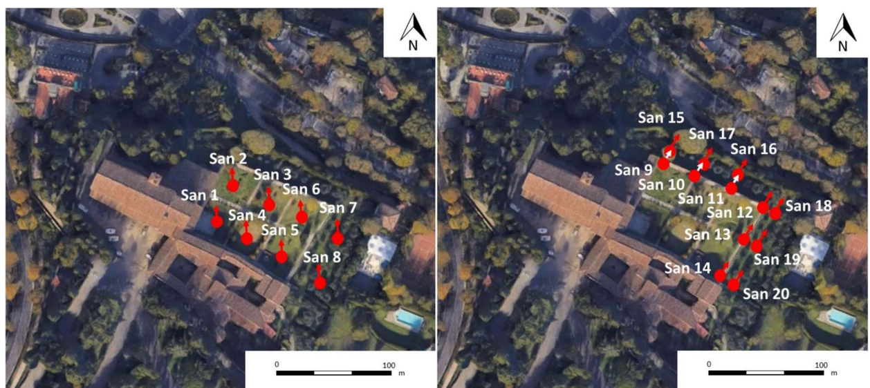
Figura 13 – Localizzazione, su immagine ottica da satellite, delle misure di microtremore ambientale a stazione singola. A sinistra: misure free field ; a destra: misure per la caratterizzazione della frequenza propria del muro. Le freccette indicano la direzione della componente nord-sud dello strumento.
