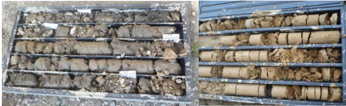
Figura 20: A destra, carotaggio orizzontale S01, come indicato nella stratigrafia di cui in figura precedente, mostra la natura del terreno di deposito antropico la cui presenza è stata rilevata subito a monte dell'opera di sostegno [1]. A sinistra, carotaggio verticale S2, come indicato nella stratigrafia di cui in figura precedente, mostra la natura delle sabbie fini giallo-ocra addensate [1].
